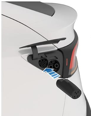
3. 将配备 A 型或 I 型插头的设备插入插座适配器。
